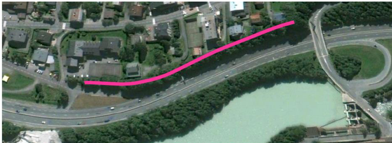
Figure 6 : Écran absorbant en crête de talus E1+E2
